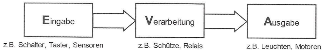
Abb. 6.17: EVA-Prinzip einer Steuerungseinrichtung
